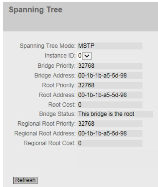
如果打开“生成树”(Spanning Tree)，则会显示“实例 ID”(Instance ID) 下拉列表中选择的实例状态的相关信息，并在表格中显示已组态端口的相关信息。显示的信息取决于生成树模式。
