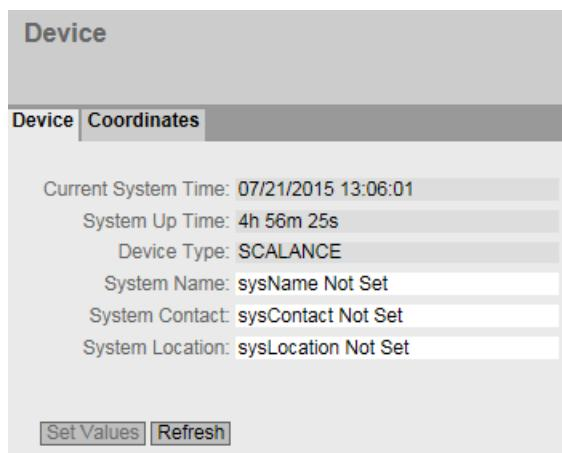
无法更改“当前系统时间”(Current System Time)、“系统运行时间”(System Up Time)和“设备类型”(Device Type) 框。
