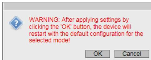
如果单击“确定”(OK) 确认消息，则设备将以出厂设置组态重启。再次登录并启动基本向导以在所选模式下继续组态设备。
